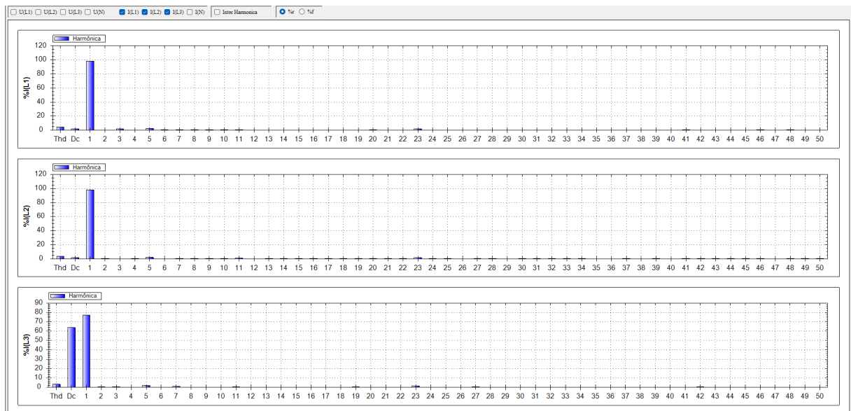
Figura 4.8 – Distorções harmônicas de corrente em regime permanente antes do soft starter. Fonte: MEGABRAS - Power View.
