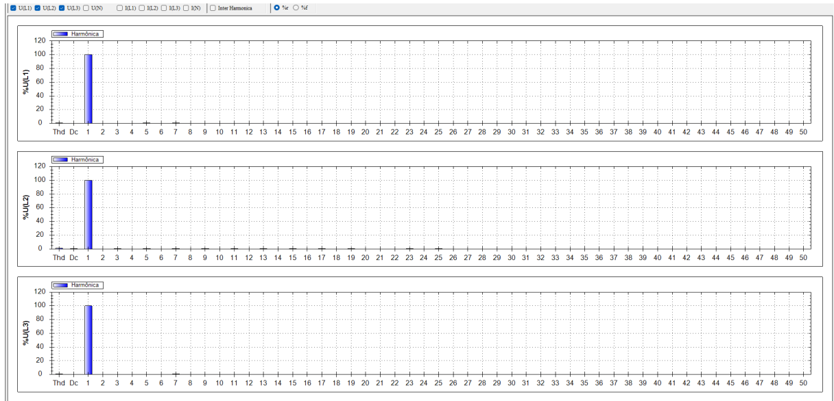
Figura 4.2 – Distorções Harmônicas de tensão - Partida Direta em Regime Permanente. Fonte: MEGABRAS - Power View.
