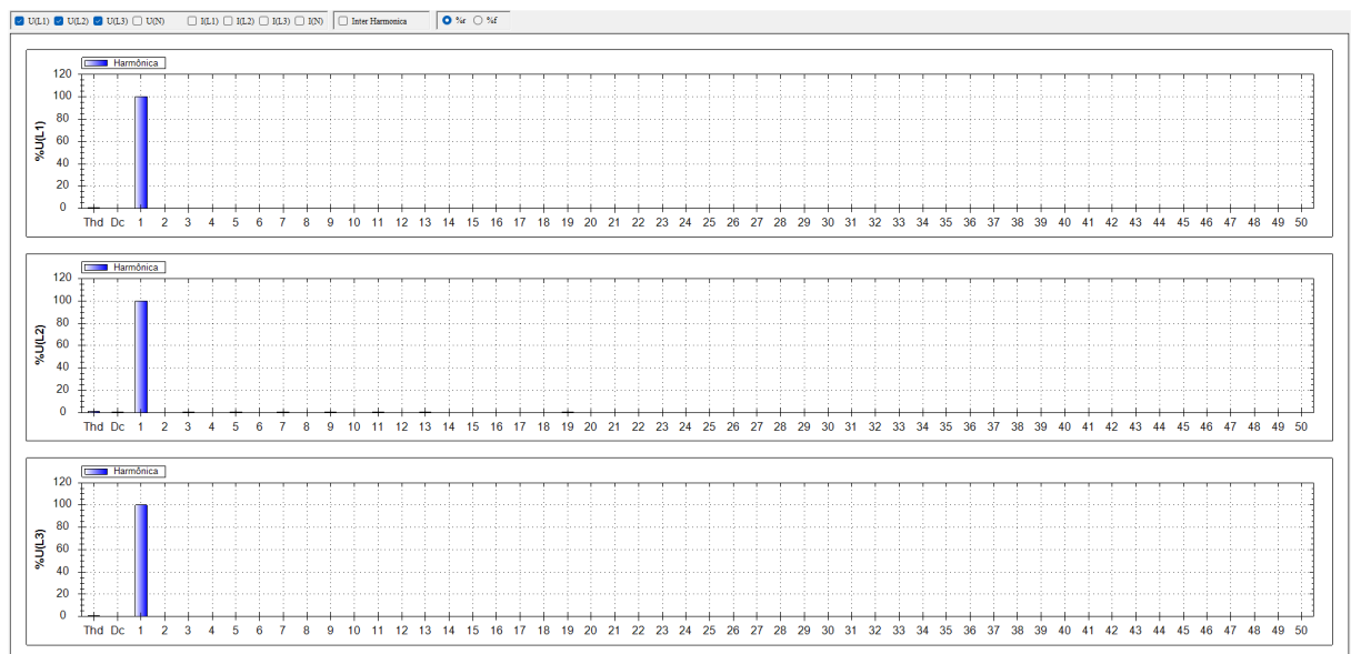
Figura 4.10 – Distorções harmônicas de tensão em regime permanente antes da carga. Fonte: MEGABRAS - Power View.
