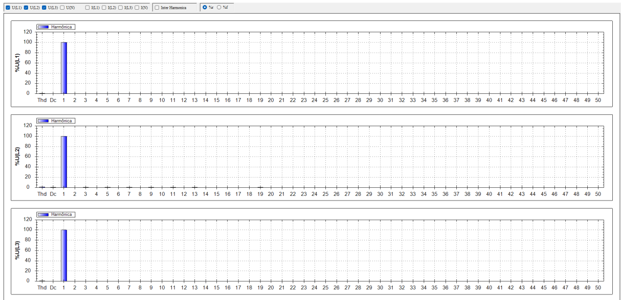
Figura 4.12 – Distorções harmônicas de corrente em regime permanente antes da carga. Fonte: MEGABRAS - Power View.
