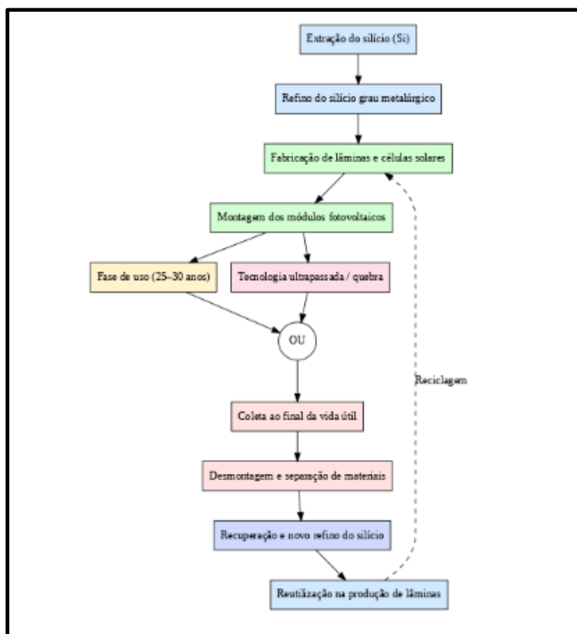
Figura 8 - Ciclo de reciclagem das Células de Silício
