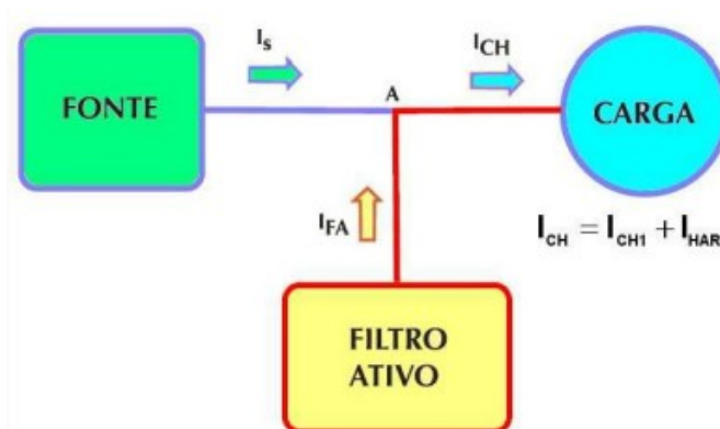
Figura 10 - Esquema da configuração típica de um filtro ativo
